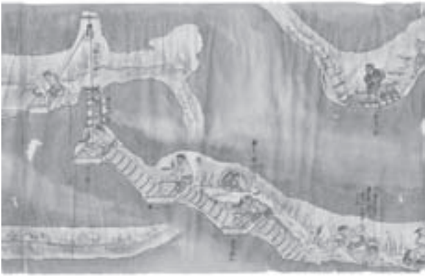
▲水上輪と釣瓶を使った排水作業の様子
