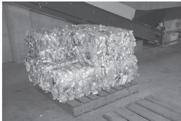
写真10 圧縮されたペットボトル
