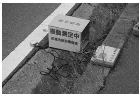
道路交通振動測定の様子
