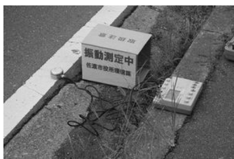
道路交通振動測定の様子
