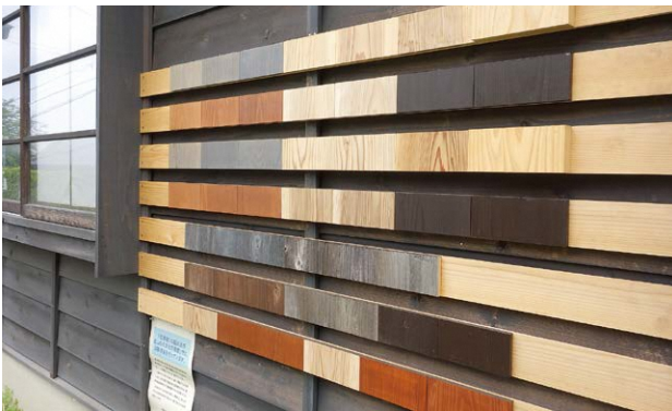
試験塗装用のパネル 板の厚みや劣化度合いなど、状態が異なる木材に、数種類の塗料を塗装して比較します。この試験では、木材の風合いが活かされる透明な保護塗料が、相川の建物に実用できるかどうかを試しています。
