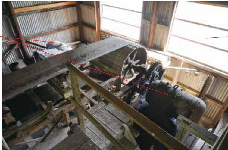
ベルトコンベア電動機 (南側)
