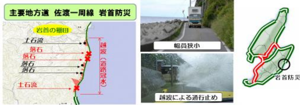
越波による道路冠水
