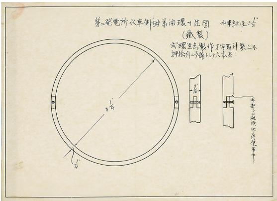
古図面 41 「第二発電所水車側軸様油環寸法図」
