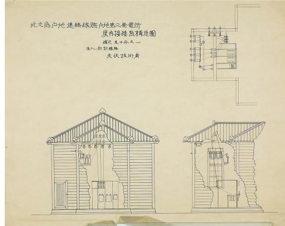
古図面 13 「北立島戶地連絡線路戶地第二發電所屋內接續點構造圖」
