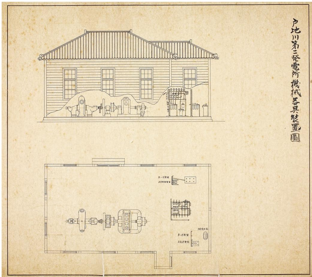
古図面 17 「戸地川第二発電所機械器具装置圖」
