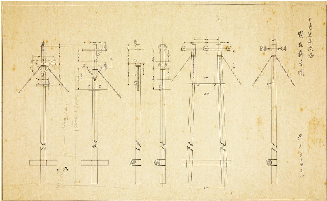
古図面 14 「戶地送電線路電柱構造圖」
