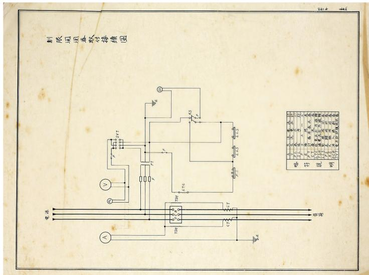
古図面 27 「制限開閉器取付接続図」
