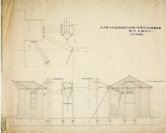
古図面 12 「北立島戶地連絡線路戶地第二發電所引込線構造圖」
