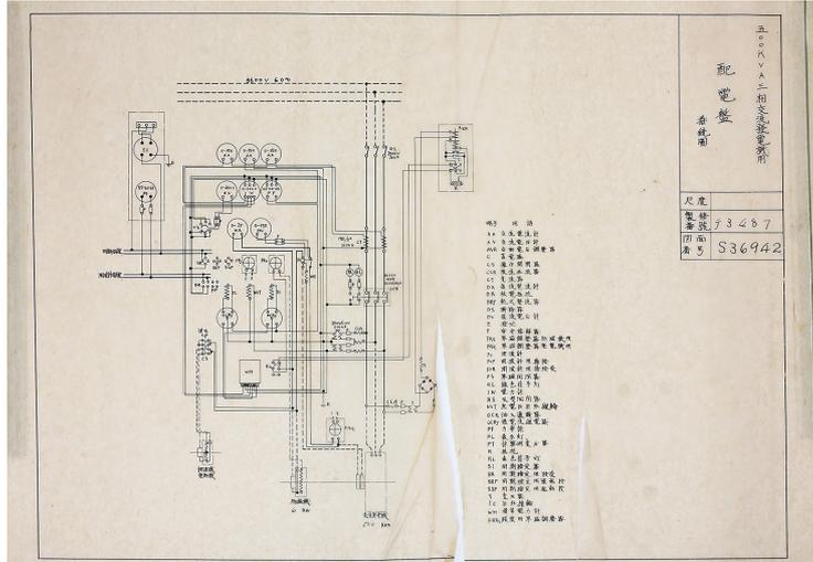
古図面 26 「五〇〇 KVA 三相交流発電機用 配電盤 接続図」
