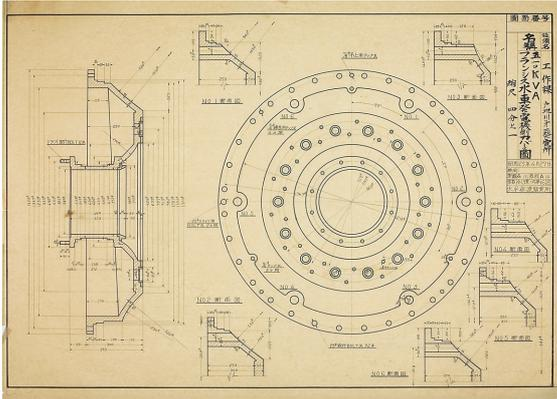
古図面 39 「五〇 KVA フランス水車発電機側カバー之圖」〔昭和 25 年 4 月 27 日〕
