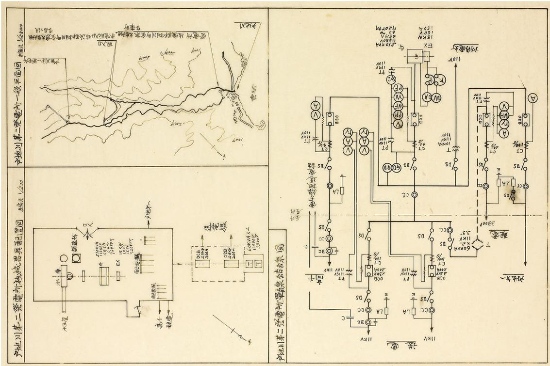
古図面 16 「戸地川第二発電所機械器具配置図 戸地川第二発電所一般平面図 戸地川第二発電所単線結線図」
