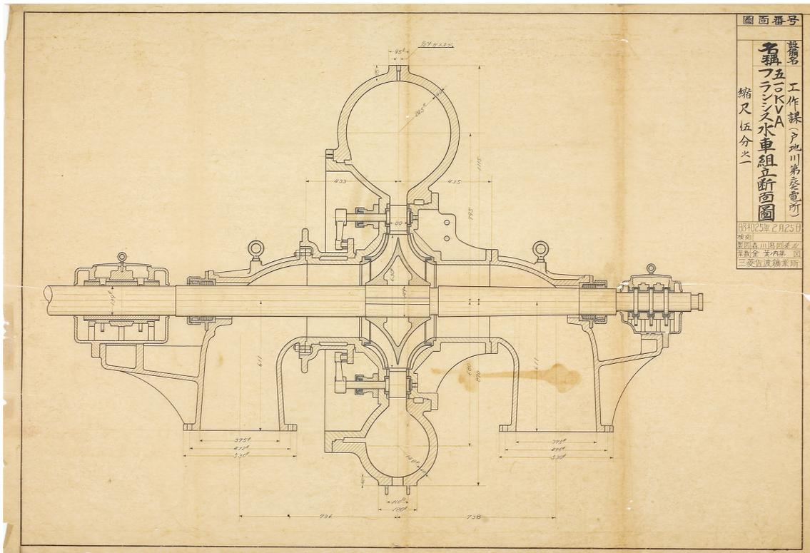
古図面 30 「五〇 KVA フランシス水車組立断面圖」〔昭和 25 年 2 月 25 日〕
