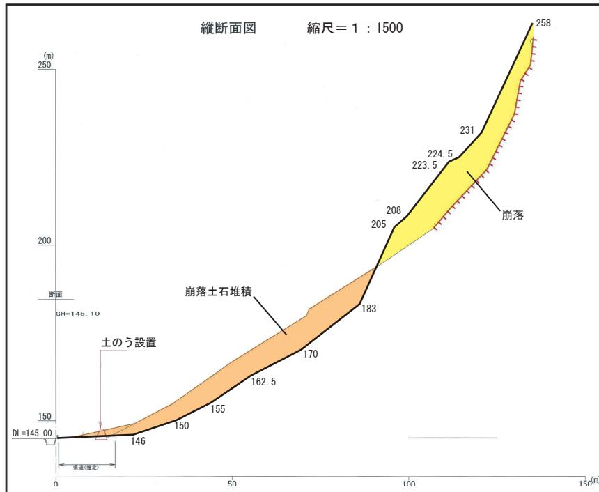
図3-12 道遊の割戸隣接地斜面崩落部断面図
