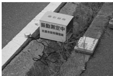
道路交通振動測定の様子
