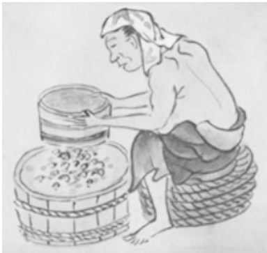
細かく砕いた鉱石を篩にかける図。篩の目に馬のしっぽの毛が使われるので、「馬の尾粉成」という。「佐渡の国金掘の巻」より
