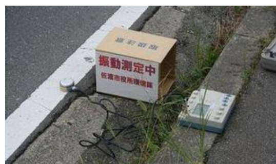
道路交通振動測定の様子
