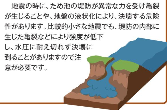
地震の時に、ため池の堤防が異常な力を受け亀裂が生じることや、地盤の液状化により、決壊する危険性があります。比較的小さな地震でも、堤防の内部に生じた亀裂などにより強度が低下し、水圧に耐え切れず決壊に至ることがありますので注意が必要です。
