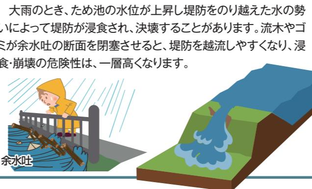
大雨のとき、ため池の水位が上昇し堤防をのり越えた水の勢いによって堤防が浸食され、決壊することがあります。流木やゴミが余水吐の断面を閉塞させると、堤防を越流しやすくなり、浸食・崩壊の危険性は、一層高くなります。
