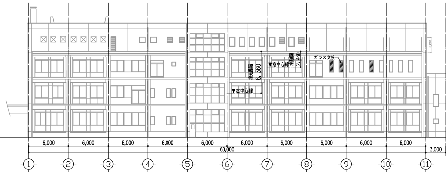
南側立面図（ガラス改修図） S=1:200
