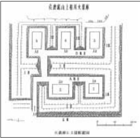
図のとおり火薬庫は1棟ごとに周囲を石垣の土塁で遮断することによって、事故に対する防衛措置をとっています。火薬庫は鉄筋コンクリート造りで、屋根と扉の一部が滅失しているものの、建物のほぼ全容を留めています。入り口は北側の山側で、土塁で挟まれた細い通路を通って各火薬庫へ入る構造であり、万一に備えて通路のさき土塁がある仕組みになっています。
